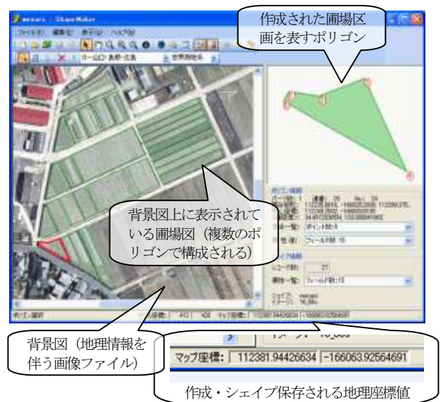
図 4 ShapeMaker 動作画面例 (地理座標付き背景図を元に圃場区画を作成する)
